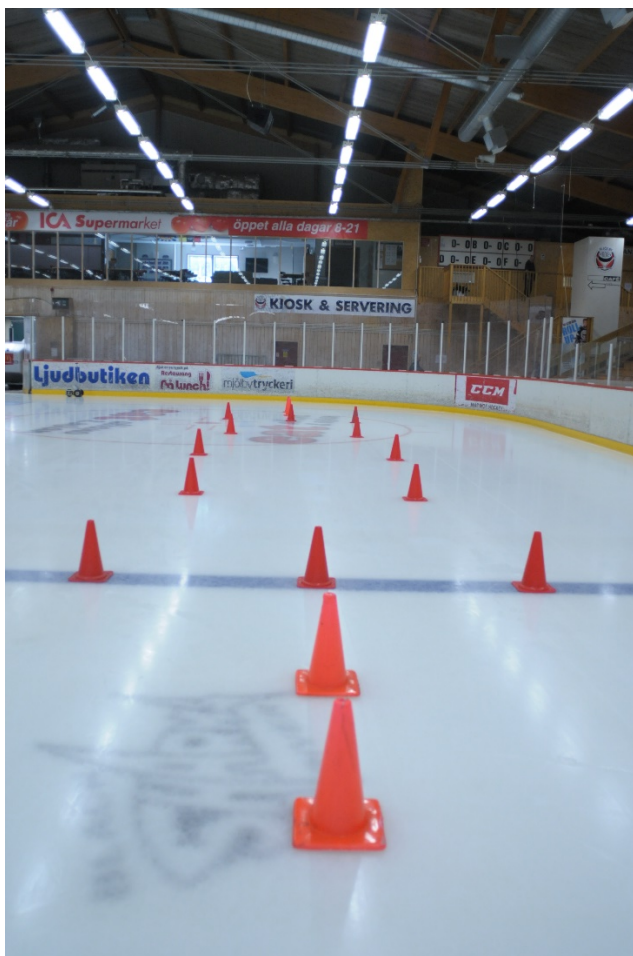
Figur 2 Slalombana för handlingtest på is. Foto: Jan Wenäll.
