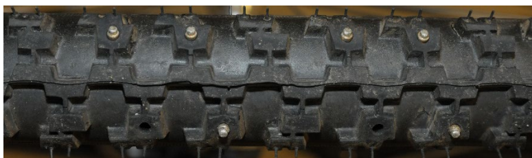
Figur 12 Bilder på de tre mest slitna däckmodellerna. Foto: Jan Wenäll.
