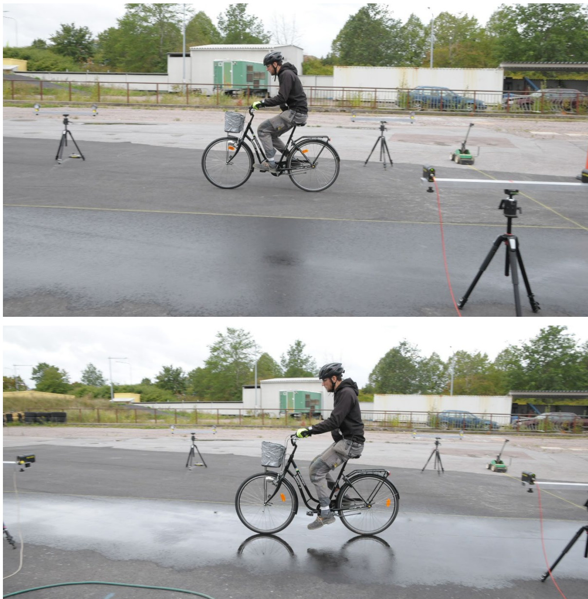
Figur 7 Bromstester på torr och våt asfalt. Foto: Jan Wenäll.
