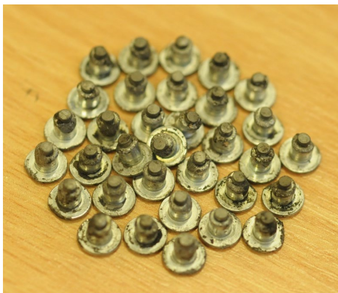
Figur 13 Några av de dubbar som lossnade vid bromstesterna på asfalt. Foto: Jan Wenäll.
