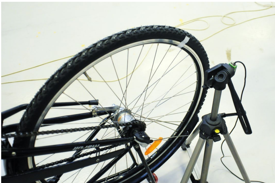
Figur 14 Mätning av navfriktionskraften. Foto: Jan Wenäll.
