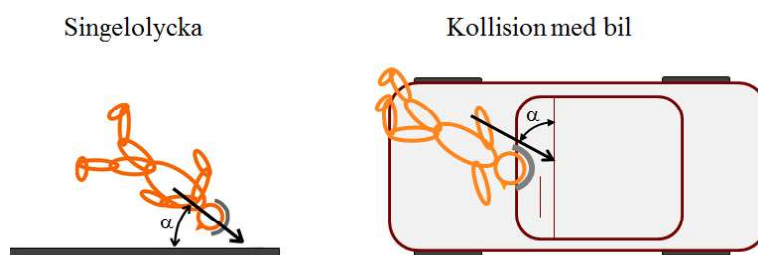
Figur 3. Schematisk bild över islagsvinkeln vid singelolyckor (vänster) och vid kollision med bil
