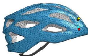
Figur 15. Den maximala töjningen i hjärnan för de tjugo olika träffpunkterna på hjälmen.
