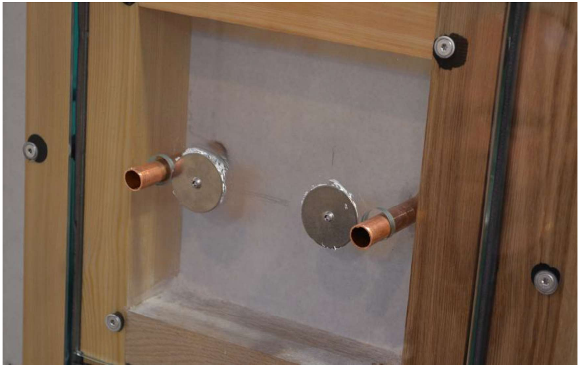
Bild 11. Vägg 2, blandarfästen limmade mot glas och rör monterade.
