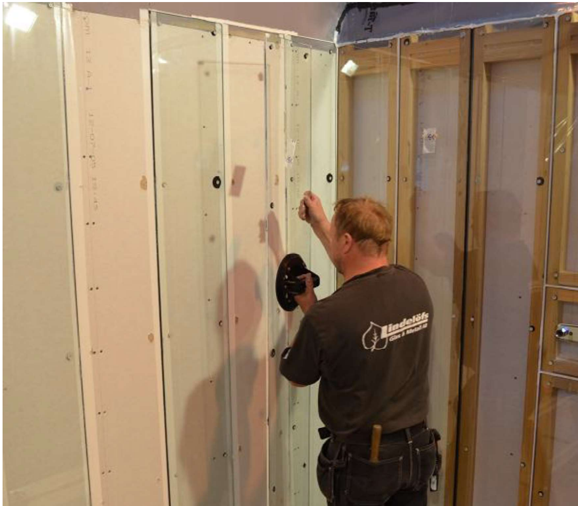
Bild 13. Byte av glaspaneler mellan vattenbegjutningsperiod 1 och 2.
