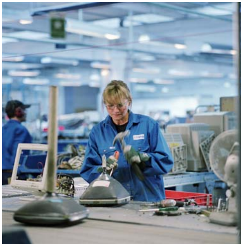
Figur 4.2 Demontering av CRT.
