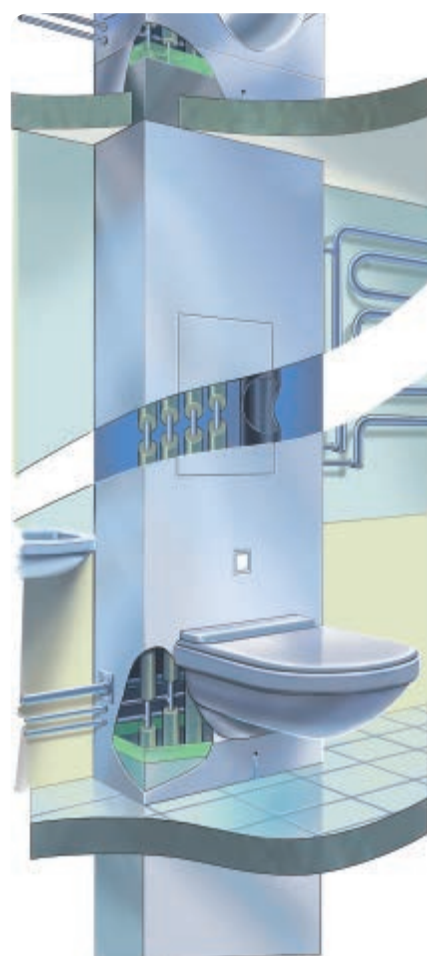
Våtrum med våtrumskassett. Tätskiktet ska vikas upp minst 50 mm på väggen och rör genomföringar i kassetten ska tätas mot fukt och brand.
