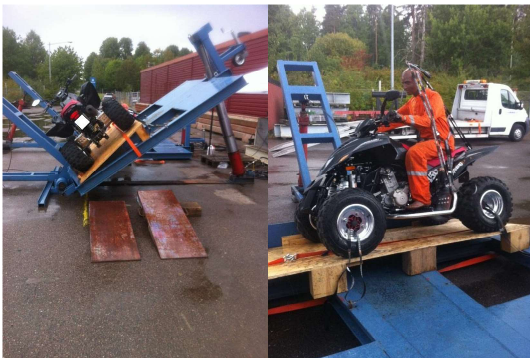
Figur 1. Test med tiltbord med och utan krocktestdocka.
