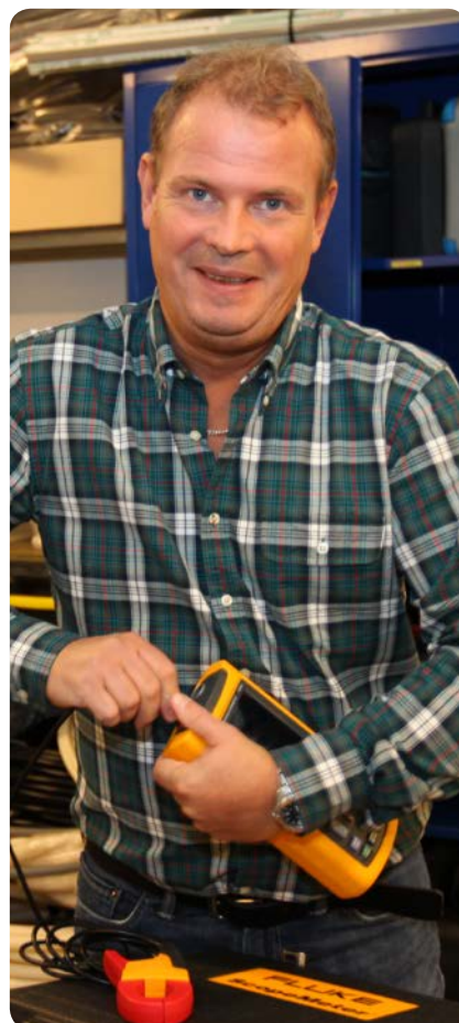
– Med den här tångamperemetern mäter man för att få samma belastning på fasen, förklarar Leif Eriksson.
