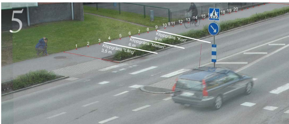
Figur 2.3 Mätning av avstånd fram till övergångsstället för olika klippgränser (9, 6 och 3,5 meter).
