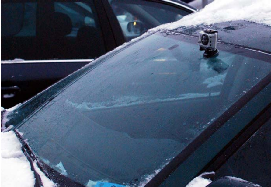
Figur 5.2 En vidvinkelkamera monterades på utsidan av vindrutan på bilen som användes vid inspelningarna
