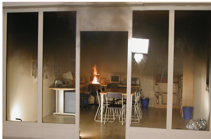
Simulerad brand i skoldatorsal. Branden anlagd i en datorskärm. Tändkällan motsvarar ett stearinljus.
